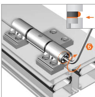
Hebespindel einschrauben, bis Lagerbuchse in Null-Stellung.
