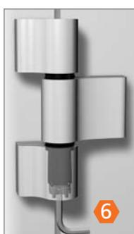
Mit Verstellstern untere Lagerbuchse um  $\pm 90^\circ$  drehen bis sie spürbar einrastet.
