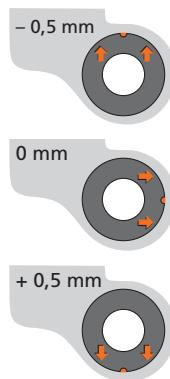
Markierung am Buchsenkragen zeigt am oberen und unteren Rahmenband nach der Verstellung nach hinten.
